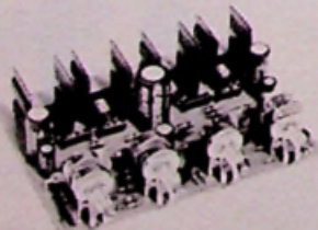
SAC.14 Stereo versterker, 2 x 7 watt sinus en 2 x 12 watt muziek, freq.ber. 40-17.000 Hz. Geheel compleet met o.a. volume, balans, bas en hoge tonen regelaar. Bijzonder geschikt voor inbouw. f 69,-
