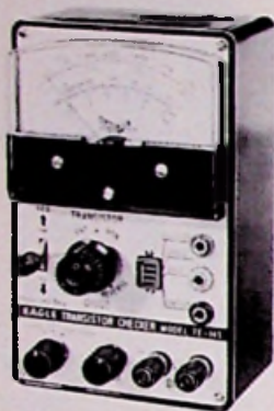
TT.145 Transistor diode-tester, een apparaat waarmee u letterlijk alles kunt doen. f 89,-
