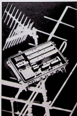
wikkelde apparaten, onder de naam GGA III t.b.v. televisie-distributie geïntroduceerd. De foto stelt de nieuwste breedband versterker voor.
